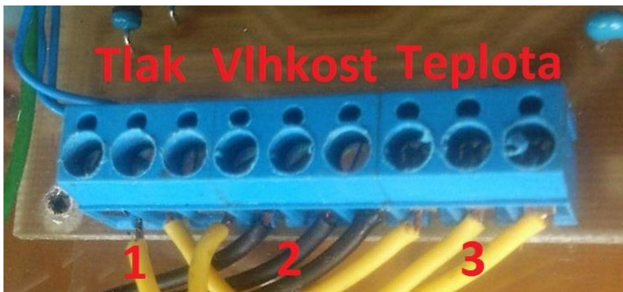
Obr. č. 9.4 Svorkovnice pro dané senzory.
