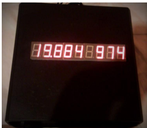
Obr. č. 11.1 Funkce meteostanice s vyříznutým otvorem pro displej.
