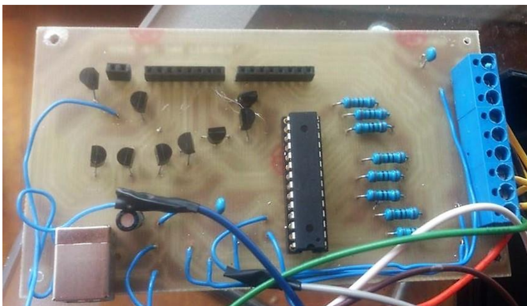
Obr. č. 7.2 Osazení z vrchní části DPS.
